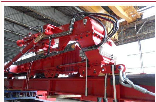
Podajnik do transportu poziomo-pionowego transportu rur osłonowych i wiercących produkcji Zamet Industry
