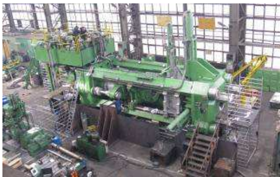
Prasa hydrauliczna o nacisku 65 MN produkcji Zamet Budowa Maszyn wraz z urządzeniami pomocniczymi, dostarczona na rynek indyjski
